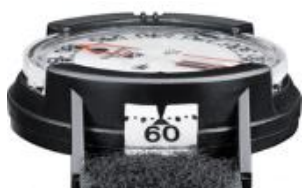
L'objet visé dans les crans de mire est à l'azimut 60°.
